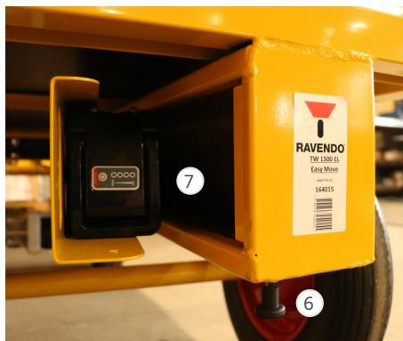
Batteriets strømniveau kan tjekkes ved at holde "TÆND" knappen inde. OBS: hold selv øje med batteriernes strømniveau, Idet batterimåleren ikke advarer ved lav strømbeholdning.
